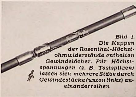
Bild 1. Die Kappen der Rosenthal-Höchst-widerstände enthalten Gewindelöcher. Für Höchstspannungen (z. B. Tastsptzen) lassen sich mehrere Stäbe durch Gewindestücke (unten links) aneinanderreihen
