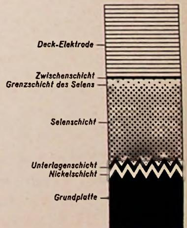
Bild 4. Schematischer Aufbau einer Selengleichrichterplatte
