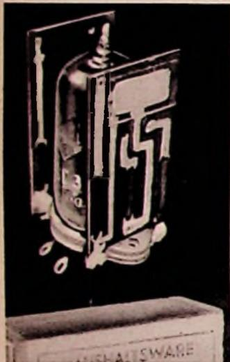
Bild 4. Ausführungsbild eines Hf-Generators gemäß Bild 6. Leitungen: Auromal. Widerstände: Grapharol. Kondensatoren: Glimmer mit Auromal-Belägen, nachträglich aufgeklebt. Grundplatten: Hartpapier
